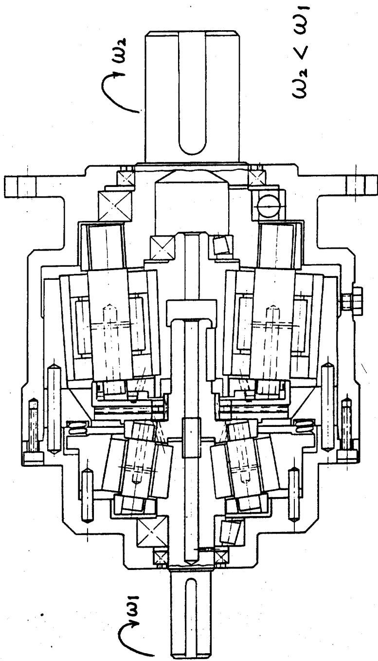
图4：双级行星式锥面摩擦轮减速机结构示例
