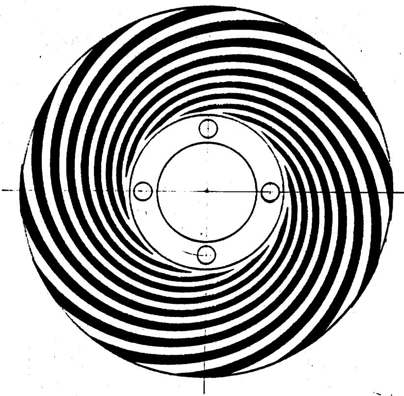
图3：螺旋槽泵油板形状示例
