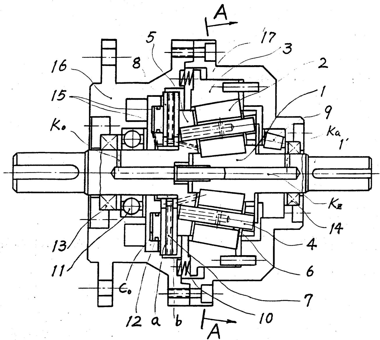
图 1：单级行星式锥面摩擦轮减速机结构示例
