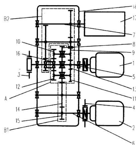
1、“WW”行星差速齿轮传动减速机，包括减速机箱体、传动机构、电动机及其制动器，所述的传动机构包含有行星差速传动和齿轮传动两部份，其特征在于：行星差速传动中的行星架（8）外沿设有齿轮，行星架（8）与输入轴（5）为活动联接；行星架（8）的两侧设置有同轴行星齿轮，其轴穿过行星架端面并活动联接于行星架（8）上；行星架（8）的外齿轮与输入齿轮（14）啮合，行星齿轮一端与输入齿轮（13）啮合，另一端与输出传动齿轮（16）啮合。
