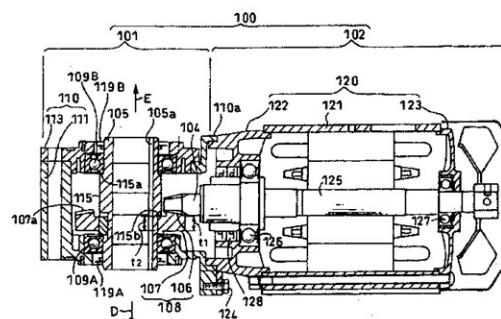
1. 一种双曲线齿轮减速机的系列，该减速机包括：
