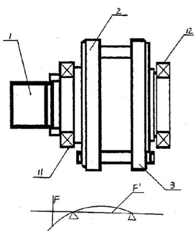
1. 一种摆线针轮减速机中 W 机构的简支梁结构，其由输出轴、轴承、均载盘构成，其特征在于：缩短输出轴（1）与前均载盘（2）的间距，并将前均载盘（2）的轴承（12）放置在后均载盘（3）后，拉大输出轴（1）的支承间距。
